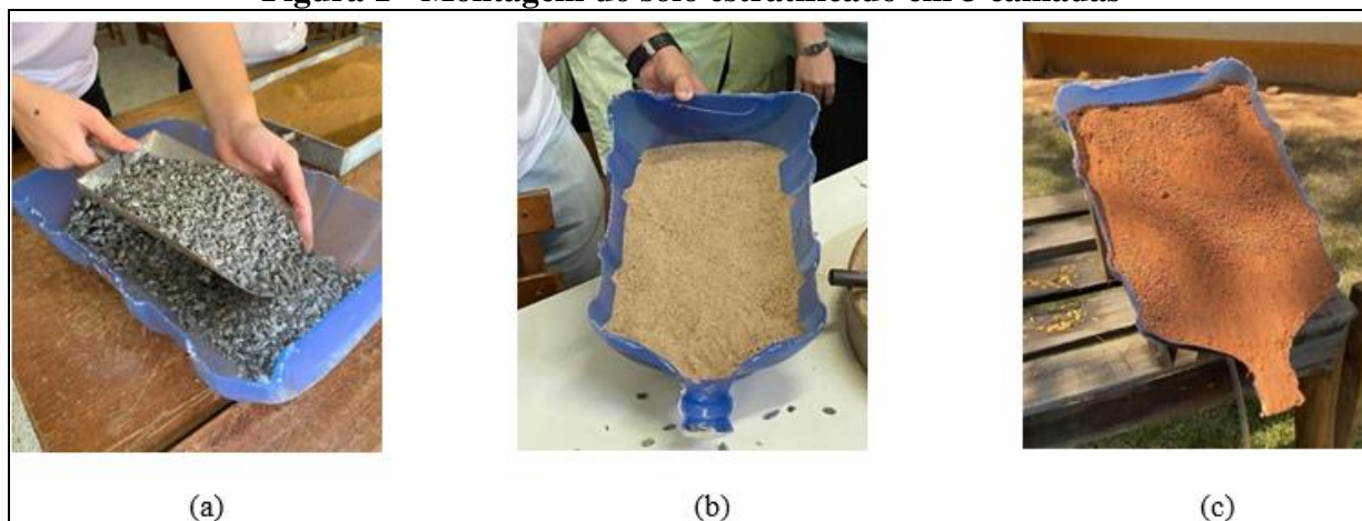
Figura 1 - Montagem do solo estratificado em 3 camadas
